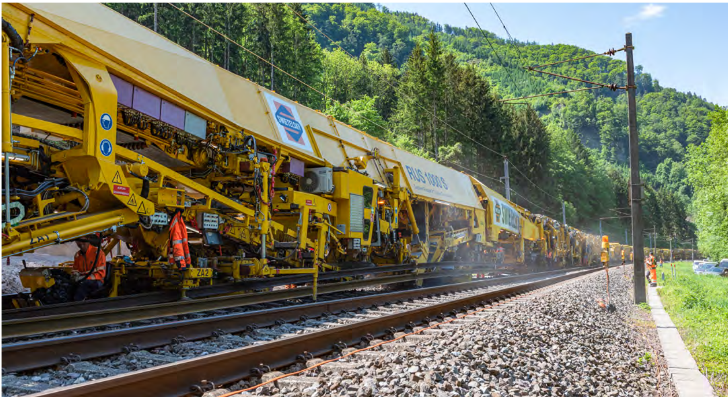
Gleisumbau & Schotterbettreinigung RUS 1000 S, Frohnleiten, Österreich
