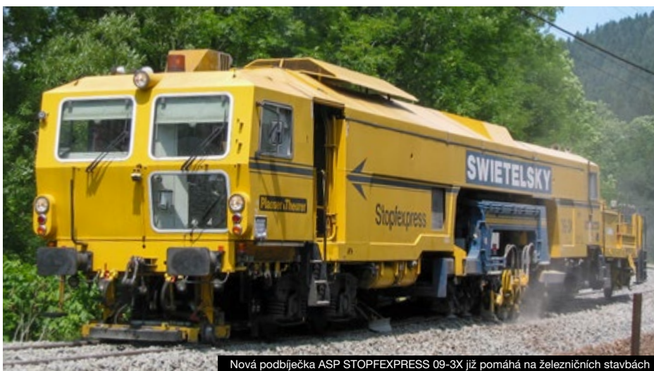
Nová podbíječka ASP STOPFEXPRESS 09-3X již pomáhá na železničních stavbách
